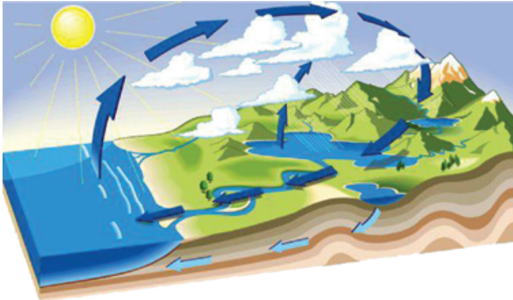
Fig. 2.4 Waterkringloop. Waterdamp uit de zee stijgt op waardoor wolken ontstaan. Uit deze wolken valt vervolgens neerslag. Via rivieren en het grondwater komt het water weer in de zee.
