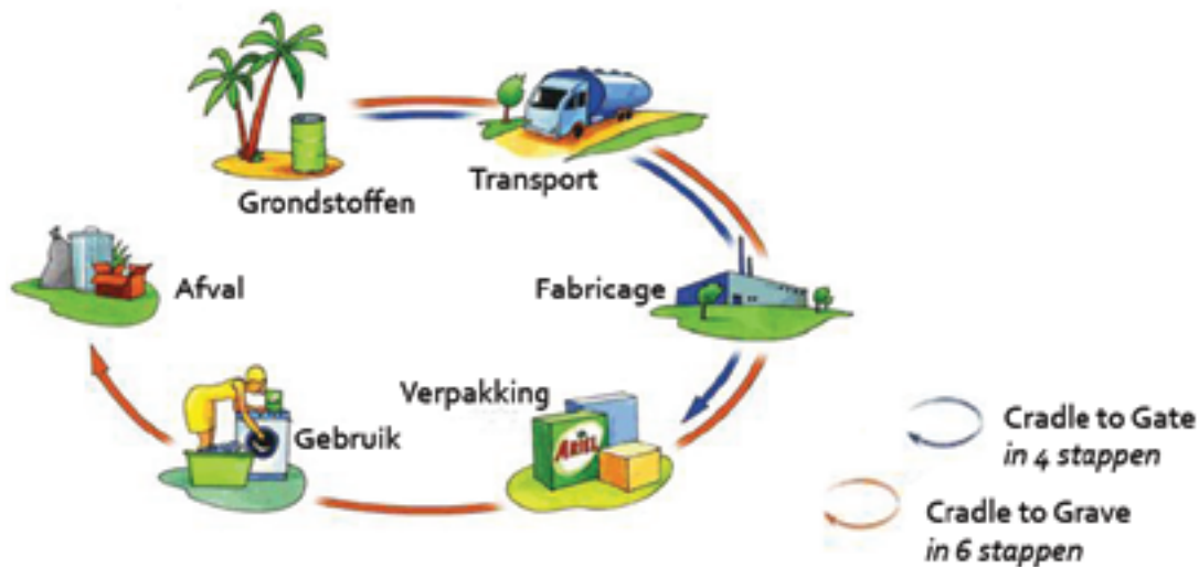
Fig. 5.1 Cradle to Grave principe schematisch weergegeven.
